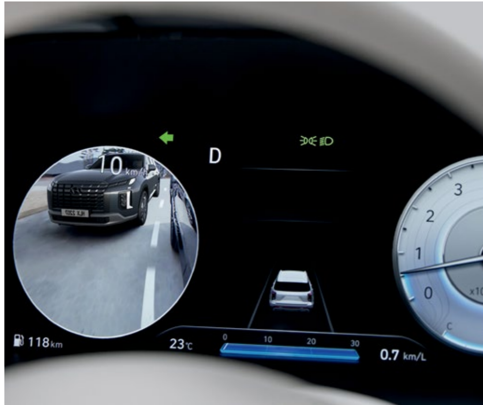
Система відеомоніторингу «сліпих» зон на панелі приладів
