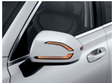
Світлодіодні повторювачі сигналу повороту на зовнішніх дзеркалах
