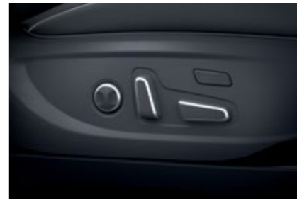
Електропривід регулювання сидіння водія з 2-рівневою підтримкою попереку
