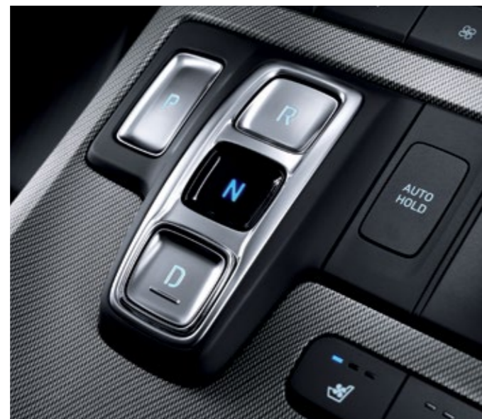
8-ступенева автоматична коробка передач з електронним перемиканням кнопочного типу
